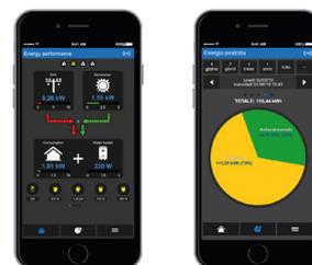
Il s'agit d'un dispositif de surveillance et de contrôle qui permet de maximiser l'autoconsommation notamment en dirigeant le surplus de production vers le ballon d'eau chaude (cumulus ou thermoplongeurs électriques jusqu'à 3 kW).
