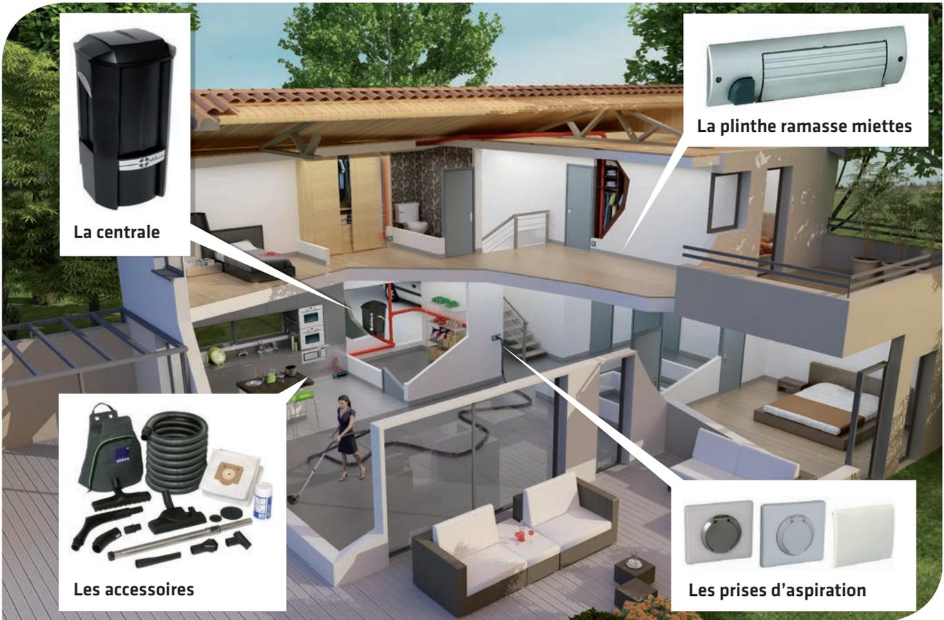
L'aspiration centralisée est un système d'aspiration basé sur l'installation de conduits à l'intérieur même de l'habitation. Elle est composée d'un aspirateur [souvent installé dans le garage], de tuyaux en PVC présents dans les murs de l'habitation. Ces derniers sont reliés à l'aspirateur et entre eux pour former un réseau qui se raccorde sur les prises d'aspiration.
